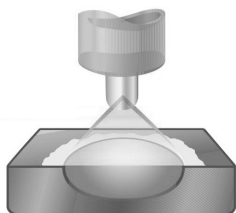
Широкая дуга, большая глубина проплавления.
