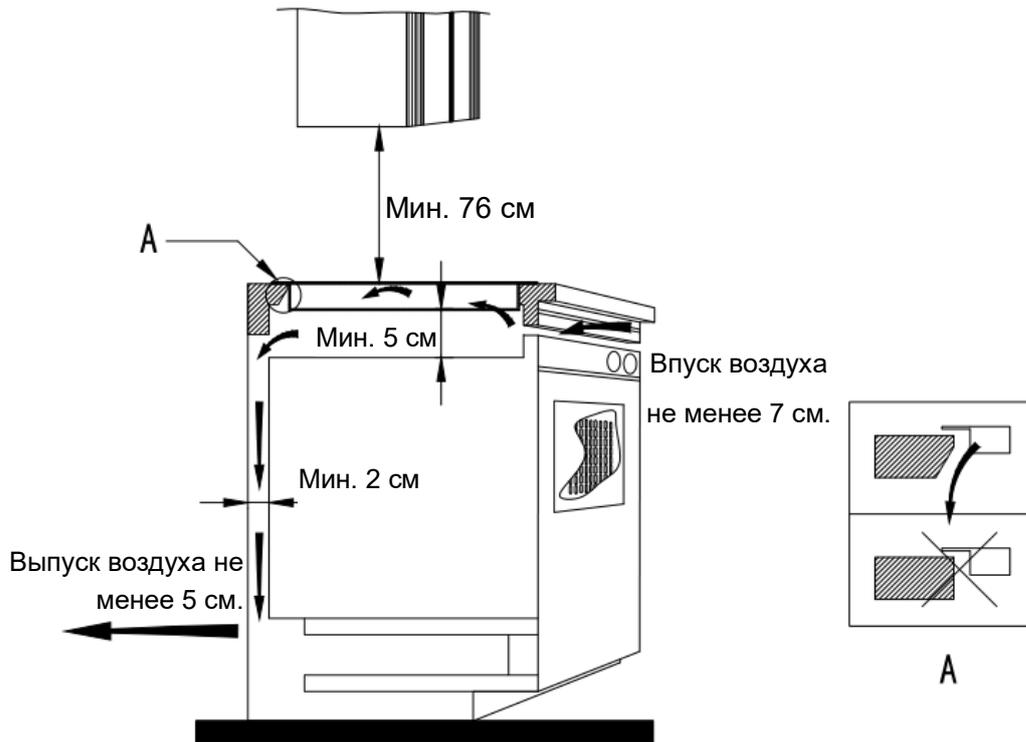
При любых обстоятельствах следите за тем, чтобы индукционная плита хорошо проветривалась, а вход и выход воздуха не были заблокированы. Убедитесь, что индукционная плита находится в надлежащем рабочем состоянии. См. рис. (2).
