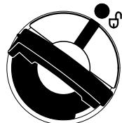
Маркировки на крышке бака и топливном баке должны друг с другом совпадать
