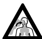
Агрегат вырабатывает ядовитые выхлопные газы, сразу же как только запускается двигатель. Данные газы могут не иметь запаха и быть невидимыми, а также содержать углеводороды и бензол. Ни в коем случае не эксплуатировать агрегат в закрытых или плохо проветриваемых помещениях – в том числе и агрегаты, оборудованные катализатором.
