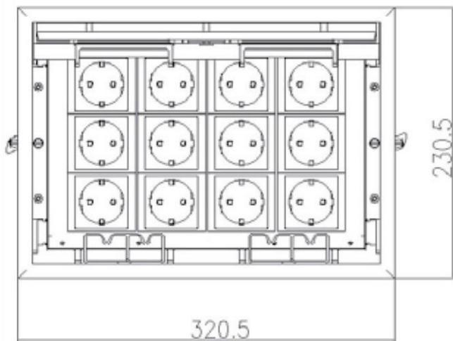
Габаритные размеры металлической коробки с крышкой для заливки в пол (арт. 70181)
