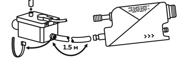
**7** Подсоедините к насосу выпускную трубку 6x9 мм, затянув соединение хомутом-стяжкой. Проверьте, чтобы на всем протяжении трубки не было заломов и других препятствий для свободного отвода конденсата.
