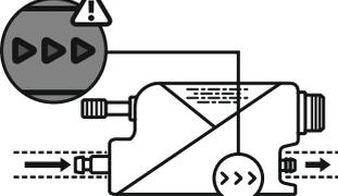
**6** Соедините насосный модуль и датчик трубкой 6x9 мм и укрепите соединения хомутами-стяжками. Длина трубки должна быть не более 1.5 м.
