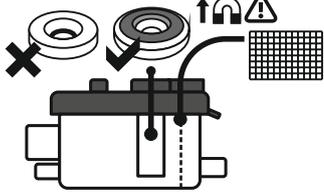
**2** Убедитесь в том, что датчик устанавливается на ровной горизонтальной поверхности.
