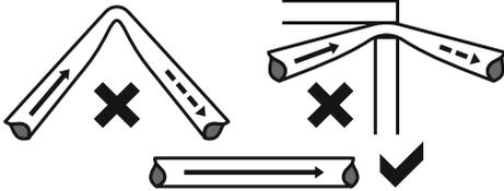
**8** Конец выпускной трубки рекомендуется не опускать ниже 2 метров относительно насосного модуля. В противном случае будет наблюдаться «сифонный эффект» и для его подавления будет необходимо установить антисифонный клапан в одном из допустимых мест (см. рисунок).
