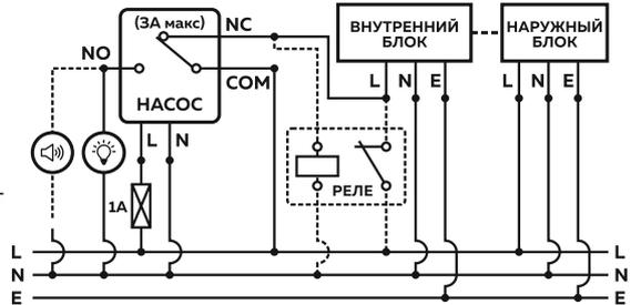
**10 ПРОВЕРКА.** Постепенно наполняя водой поддон испарителя кондиционера дождитесь включения и последующего выключения насоса. Повторите испытание, увеличив скорость наполнения. Убедитесь в корректном отработывании аварийной ситуации – отключении установки при достижении водой аварийного уровня. Удостоверьтесь в отсутствии протечек в дренажной системе.
