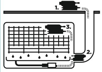
**4** Для предотвращения распространения вибрации и шума закрепите насосный модуль при помощи входящей в комплект самоклеющейся подложки.
