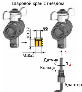
Рис. 2. Монтаж термодатчика в гнездо шарового крана.
