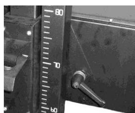
Оптические камеры регулируется по высоте с помощью слайдов на точных, бесшумных, пластиковых полозьях, на колонке помеченных с сантиметровой шкалой для точного позиционирования относительно фар.
