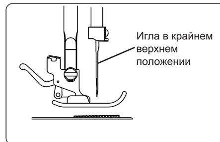
а: рычагом подъёма лапки (18) поднимите прижимную лапку вверх.
