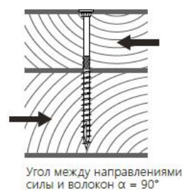
Шурупы, вкручиваемые без засверливания, мм Плотность: 420 \leq \rho_k \leq 500 \text{ kg/m}^3
