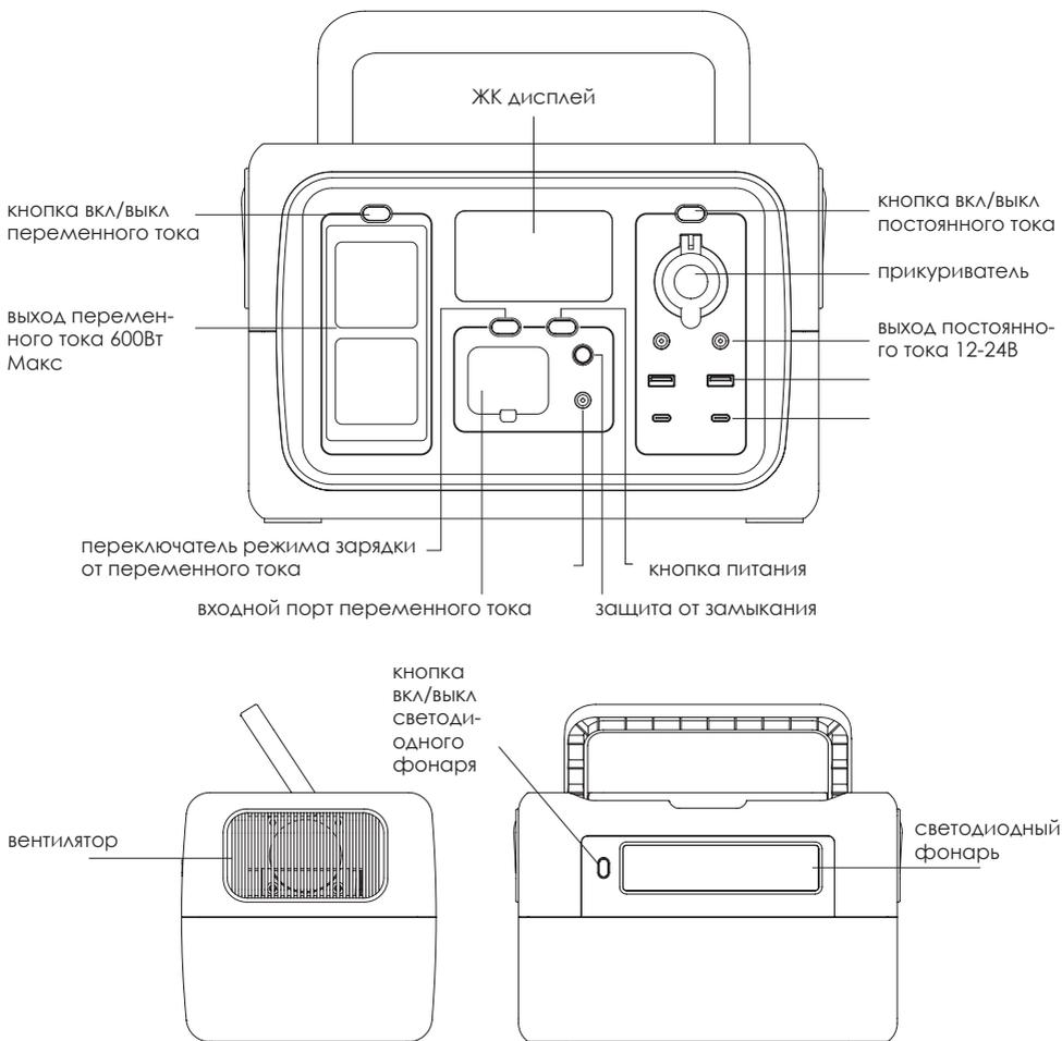
\*Защита от замыкания представляет собой электрический выключатель, предназначенный для защиты вашего устройства от повреждений, вызванных токовой перегрузкой или коротким замыканием. Если выход переменного тока превышает 4 А или 800 Вт – он отключится автоматически. Нажмите на выключатель для того, чтобы перезагрузить устройство после устранения неисправностей.
