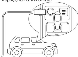
**⚠** Прикуриватель **ДОЛЖЕН** быть полностью вставлен в гнездо прикуривателя автомобиля.
