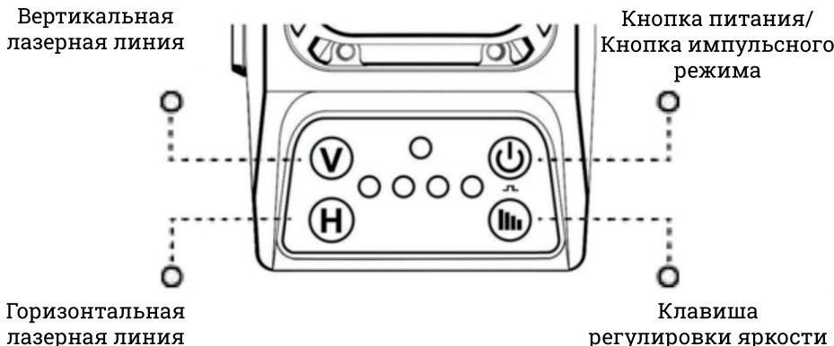
Чтобы выключить измерительный инструмент, передвиньте переключатель блокировки в положение «Заблокировано».
