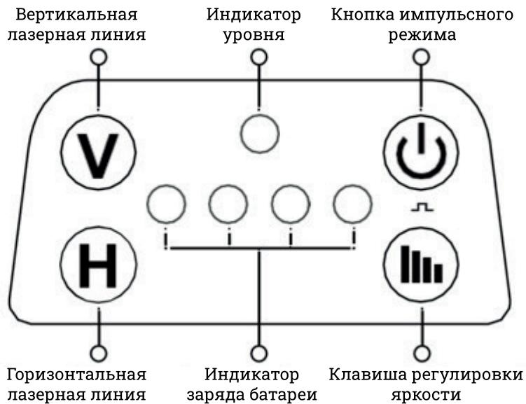
**ПРИМЕЧАНИЕ.** Четыре индикатора заряда батареи – аккумулятор полностью заряжен. Один индикатор заряда батареи – аккумулятор разряжен.
