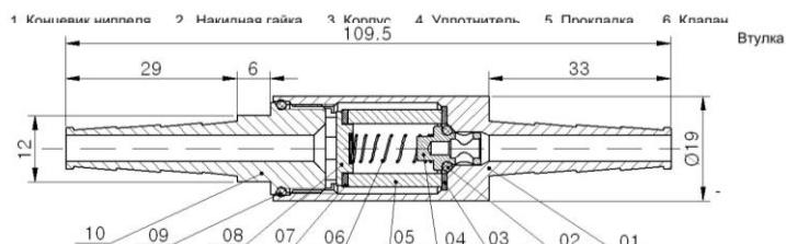
1. Клиновидный шариковый клапан 2. Накидная гайка 3. Колпачок 109.5 4. Уплотнитель 5. Прокладка 6. Клапан 7. Пламяпреграждающий элемент 8. Пружина 9. Прокладка 10. Втулка
