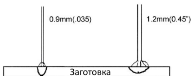
Сравнение проплавления при одинаковом токе (200А) для разных диаметров проволоки
