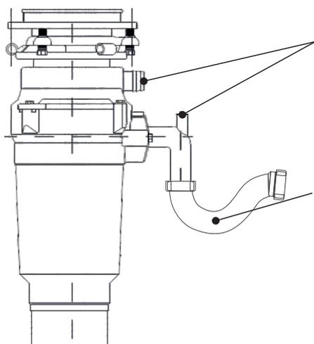
Посудомоечную машину, стиральную машину, перелив раковины нужно подключать **ТОЛЬКО ЧЕРЕЗ ОБРАТНЫЙ КЛАПАН.**
