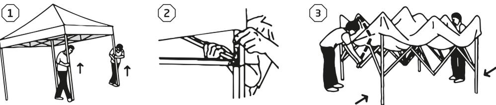
1. Откройте липучки и отделите ткань тента от каркаса. Слегка приподнимите две внешние ножки, нажмите кнопку защелки, вставьте внутренние ножки во внешние. Повторите на противоположной стороне.
