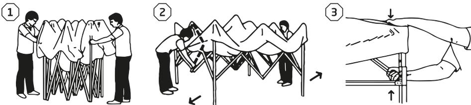
1. Разместите конструкцию на свободной и ровной поверхности, которую необходимо укрыть. Общая площадь для раскрытия и сборки конструкции тента – 4\*4 метра. Для сборки необходимо 1-2 человека. Взявшись за две внешние ножки с противоположных сторон, приподнимите конструкцию. Расположите верхнюю часть тента на конструкцию.
