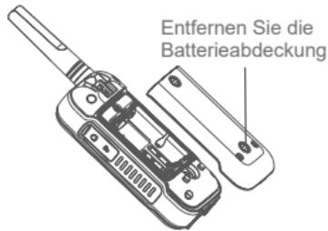
3. Schließen Sie die Batterie und ziehen Sie die beiden Schrauben im Uhrzeigersinn fest.
