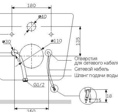
Установите шумоизолирующую прокладку через унитазные шпильки, отверстия должны совпадать с отверстиями впускной трубы и фановой трубы. Водопроводный шланг и сетевой кабель должны быть пропущены через отверстия в шумоизолирующей прокладке
