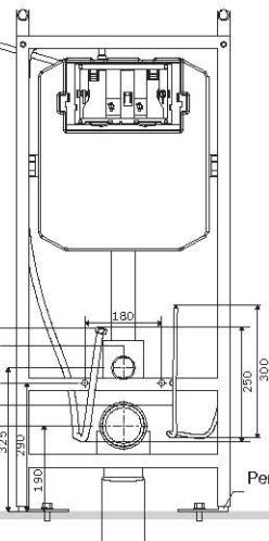
Установите систему инсталляции для подвесного унитаза и выведите шланг подачи воды и сетевой кабель из стены
