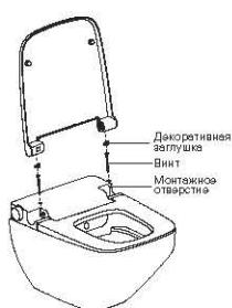
После установки керамики нажмите кнопку быстрого съема крышки сиденья и снимите крышку. С помощью отвертки закрутите винт, чтобы надежно зафиксировать верхнюю крышку.
