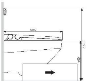
После окончания монтажа удалите подставку, двигая ее в направлении стрелки.
