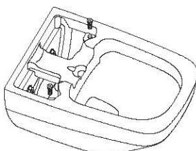
Вставьте пластиковые втулки в монтажные отверстия в унитазе.
