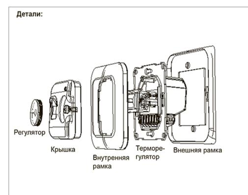
Порядок монтажа терморегулятора:
