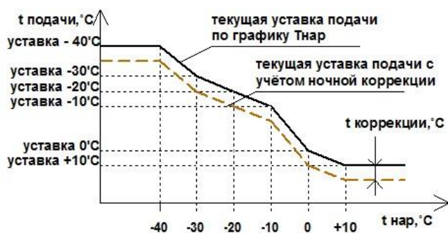
Рис. 4. Задание подачи отопления и ночная коррекция.
