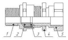
Рис.4 Внешний вид кабельного ввода серии КНТ/КНХ
