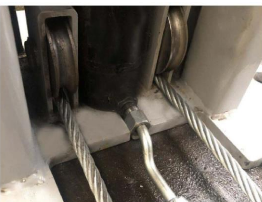
Рис. 10. Монтаж трубы. Вначале не затягивать крепления с двух сторон, чтобы деталь не упала.
