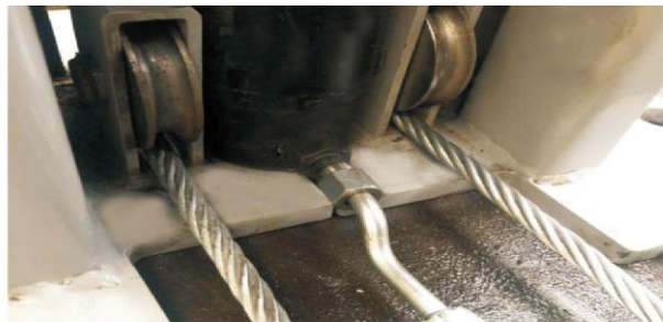
Рис. 10. Монтаж трубы. Вначале не затягивать крепления с двух сторон, чтобы деталь не упала.
