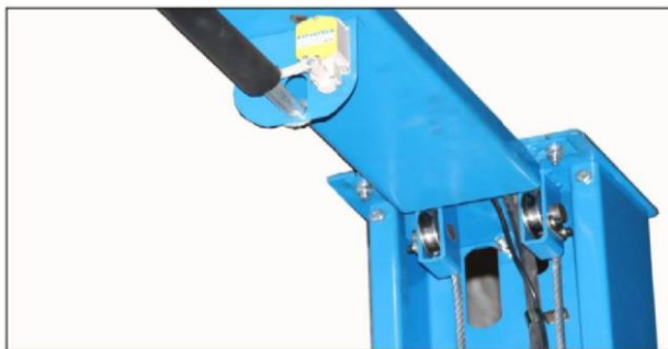
Рис. 15. Паз направлен вверх, маслопровод и электрический кабель проходят через прорезь и зафиксированы с помощью хомута, концевой выключатель установлен на стационарной пластине рядом с насосной станцией.
