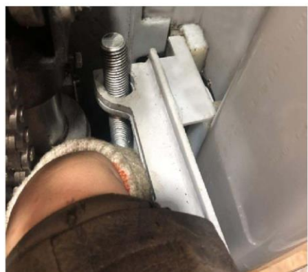
Рис. 9. Закрепить трос в отверстии и затянуть гайки с двух сторон.
