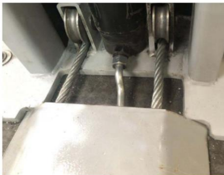
Рис. 12. Установить кожух трубы и закрепить его, вставив в пазы опорной плиты.
