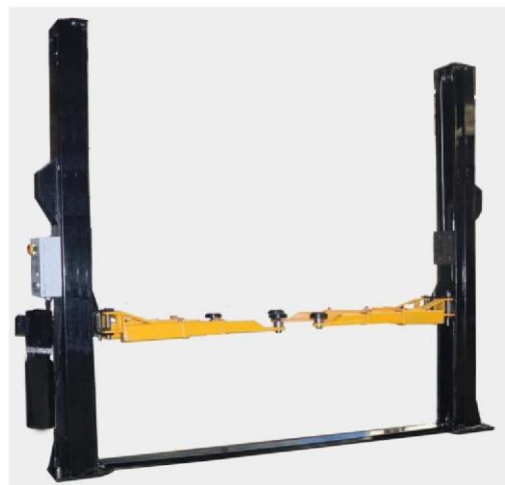
Рис. 24. Подъемник после 3-го этапа монтажа
