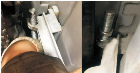
Рис. 9. Закрепить трос в отверстии и затянуть гайки с двух сторон.
