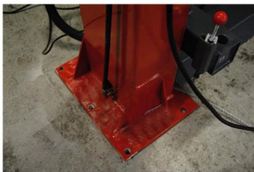
Рис. 13. Установить разжимающий винт.
