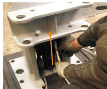
Рис. 8. Монтаж трубы. Вначале не затягивать крепления с двух сторон, чтобы деталь не упала.
