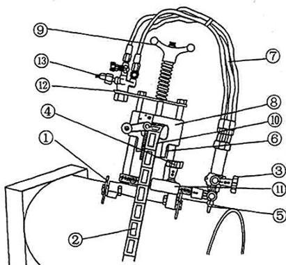
1. Колесо. Четыре колеса обеспечивают машине устойчивость на трубе.
