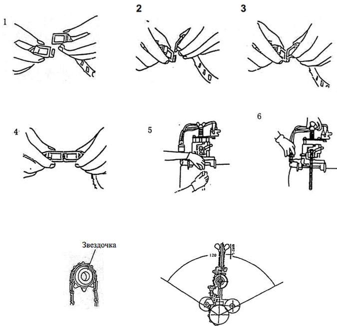
1. Вычислить необходимое количество звеньев цепи. Установить машину на трубу в зоне резки и отвернуть барашек штока, чтобы освободить пружину и опустить натяжной механизм.
