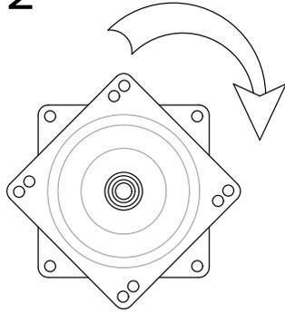
Для удобства монтажа необходимо повернуть верхнюю часть поворотного механизма относительно нижней на 45°
