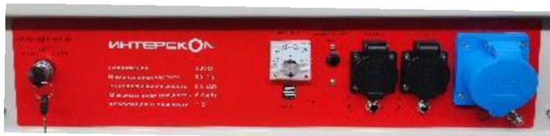
Кроме выходов на 220 Вольт на генераторах моделей ЭБ-6500Э, ЭБ-7500Э панели снабжены розетками USB постоянного напряжения на 5 Вольт, мощностью 1 Ам и 1,5 Ам.
