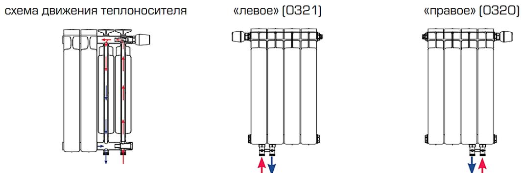
В случае одностороннего бокового подключения радиатора (снизу-вверх) с числом секций более 12 шт., для оптимальной теплоотдачи, рекомендуется во впускной коллектор установить направляющую потока длиной  $\approx \frac{2}{3}$  длины радиатора;
