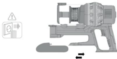
Чтобы установить батарейный блок на корпус пылесоса, нажмите на кнопку установки/снятия батарейного блока и прижмите батарейный блок на его посадочное место.,
