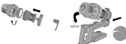
Снова соберите фильтры и установите их обратно в контейнер для сбора пыли, а контейнер установите на пылесос: для этого вставьте крючок в отверстие, а затем прижмите заднюю часть до фиксации, при этом должен раздаться щелчок.
