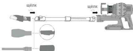
Выровняйте удлинительную трубку относительно воздухозаборной трубы пылесоса и прижмите до щелчка.
