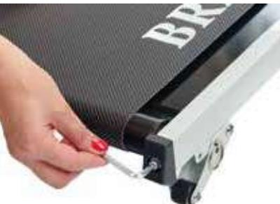
Сначала проверьте натяжение полотна беговой дорожки (полотно натягивается закручиванием болта по часовой стрелке, и ослабляется раскручиванием болта против часовой стрелки). Как показано на рисунке.
