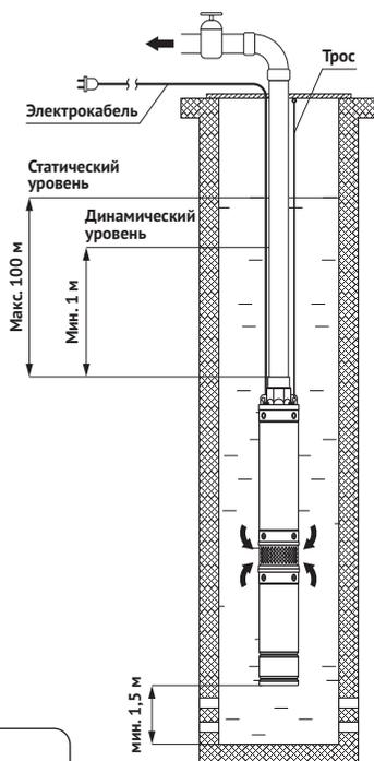
Рисунок 2 - Схема установки
