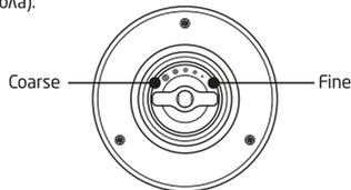
**ВАЖНО!** не закручивайте/раскручивайте винт до упора, это может привести к поломке прибора.
