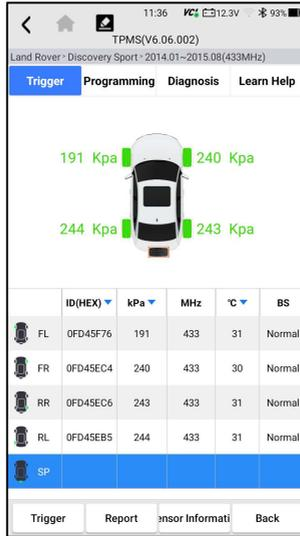
Рисунок 11-7 Пример экрана TPMS запуска
