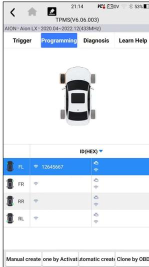
Рисунок 11-12 Пример клонирования с помощью экрана функции активации
