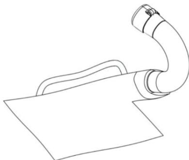
3. Затяните винты, чтобы закрепить мешок на устройстве.
