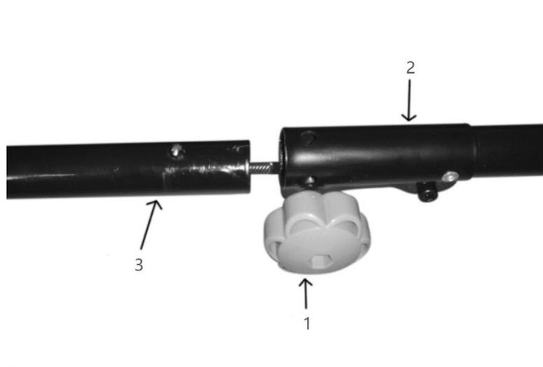
**ПРИМЕЧАНИЕ:** если фиксирующая кнопка не выходит полностью в направляющую выемку (штанги не заблокированы), слегка поверните штангу, пока кнопка не зафиксируется полностью.
