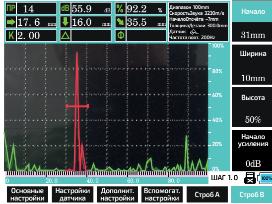
Рис. 45. Совмещение строба и эхосигнала
