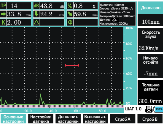
Рис. 36. Эхосигнал после установки датчика
