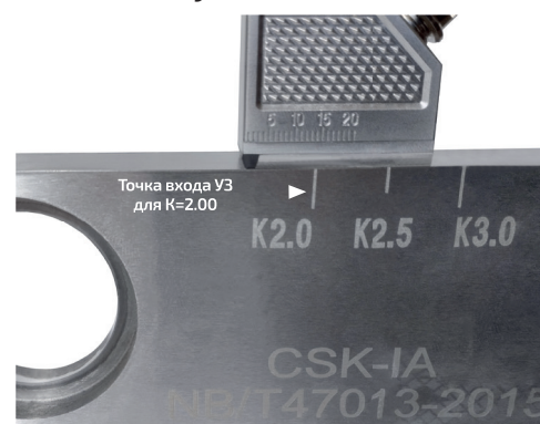
Рис. 19. Установка датчика для второго этапа
