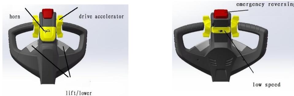
Horn – звуковой сигнал; drive accelerator – высокая скорость; lift/lower – кнопки управления «вверх»/«вниз»;
