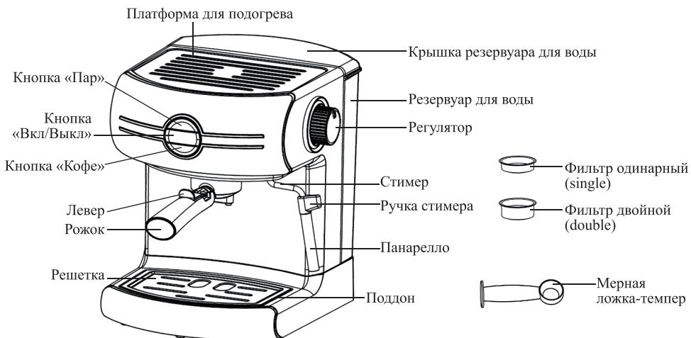
**Кнопка «Вкл/Выкл»** включает и отключает кофеварку. После нажатия на кнопку «Вкл/Выкл» выполняется нагрев бойлера до температуры приготовления кофе, индикатор кнопки «Вкл/Выкл» мигает. Когда кофеварка достаточно нагреется для приготовления кофе или подачи горячей воды, индикатор кнопки «Вкл/Выкл» будет гореть непрерывно.
