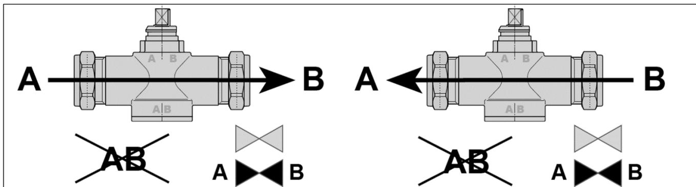
Трехходовые клапаны обеспечивают проход перемещаемой среды – между нижним патрубком и одним из боковых (как на сливание потоков, так и на разделение) в зависимости от положения золотника.
