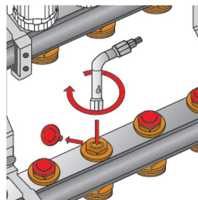
Настройку балансирующих расходомеров производят непосредственно на проектные значения расходов при запущенной системе отопления в следующей последовательности:
