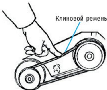
Ослабьте на несколько оборотов болт 2 крепления ролика 1 натяжения ремня, и сдвиньте ролик по направляющему пазу в нужную сторону. Затяните болт 2 крепления ролика натяжения ремня.
