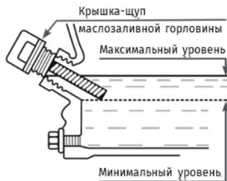
3. Проверьте уровень моторного масла в картере двигателя. Поставьте виброплиту на горизонтальную поверхность, открутите масляную крышку-щуп, уровень масла должен быть по срез маслозаливной горловины. При необходимости залейте масло. Проверьте надежность установки крышки-щупа маслозаливной горловины перед каждым запуском двигателя.
