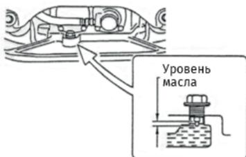
5. Снимите пробку в узле вибратора и проверьте уровень масла. Уровень масла должен быть до масляной пробки. Каждый месяц или каждые 200 часов эксплуатации, меняйте масло.
