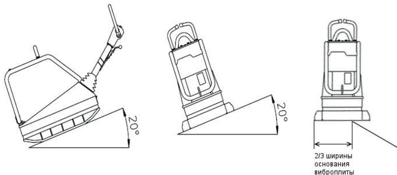
При уплотнении на наклонных поверхностях (откосы, склоны) соблюдайте следующее:
