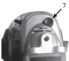
3) Теперь установите диск внешнего фланца (2) и затяните его с помощью натяжного ключа (5). Нажмите и удерживайте фиксатор шпинделя (7), чтобы шпиндель не вращался во время затяжки.
