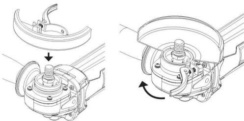
Установите ограждение (3), как показано на рисунках слева. Отрегулируйте силу зажима стопорного рычага, затянув винт с шестигранной головкой или разгрузив стопорный рычаг.
