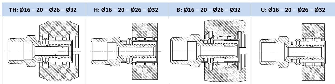
Проверка соединений на герметичность осуществляется в течение 30 мин. давлением воды в трубопроводе в 1,5 раза превышающем рабочее, но не менее 6 бар.
