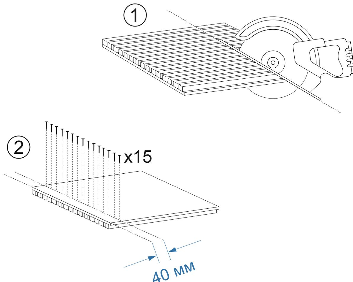
Если требуется изменить длину панели используйте циркулярную пилу или ручную пилу с мелким зубом
