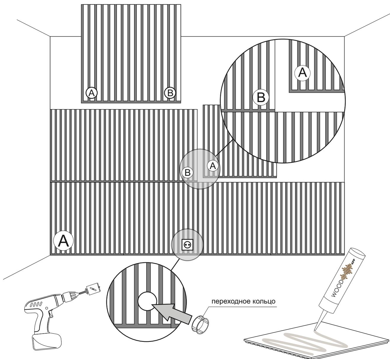
Монтаж панелей Wood App возможен так же и на специальный клей, при этом стена должна быть ровной, без выпирающих дефектов
