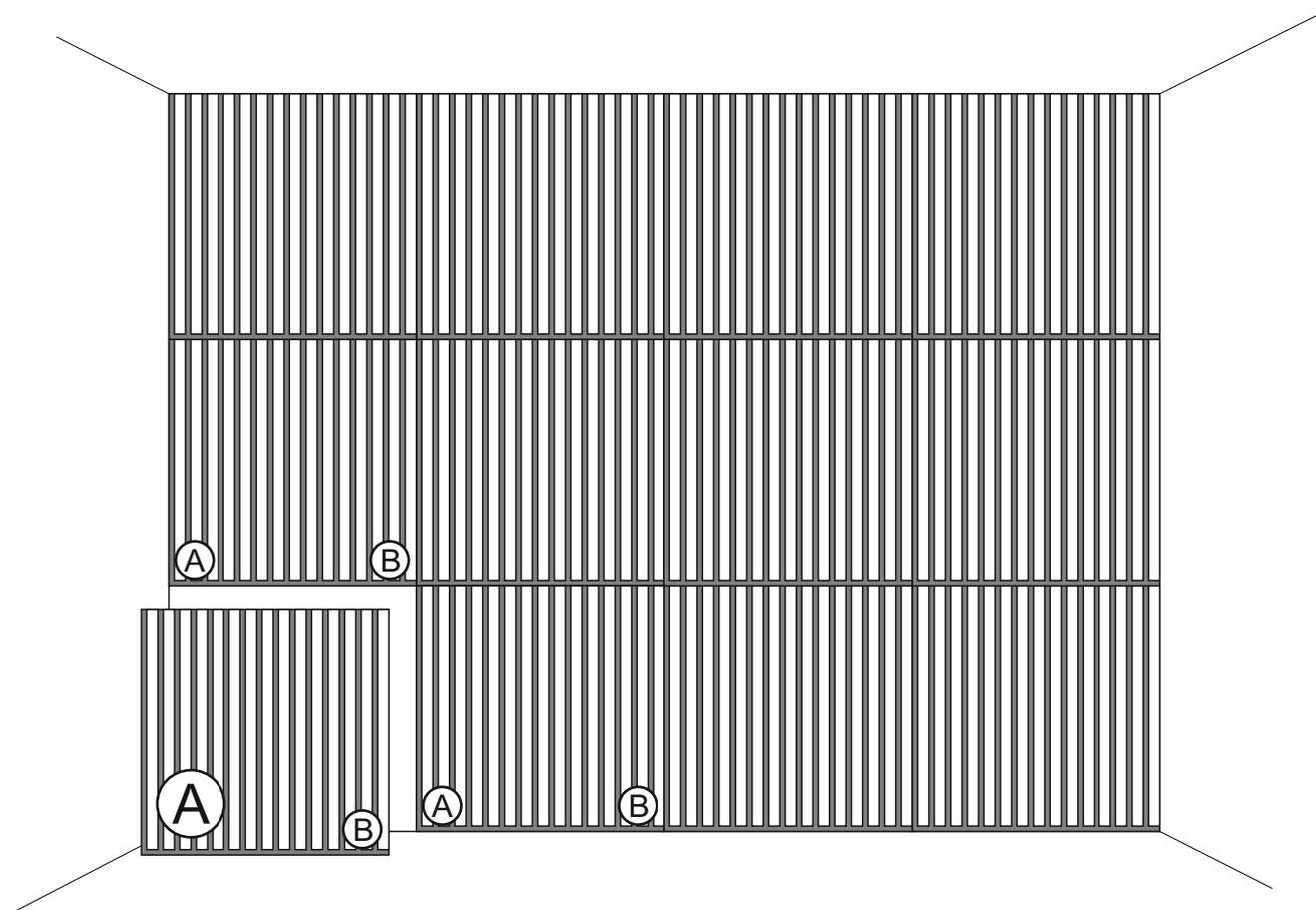
При монтаже панелей коллекции CUBE вертикально, необходимо ориентироваться на базовый угол панели, обозначенный на рисунке буквой «А», имеющий выступающие части фетра. Последующие панели необходимо монтировать совмещая углы «В+А»
