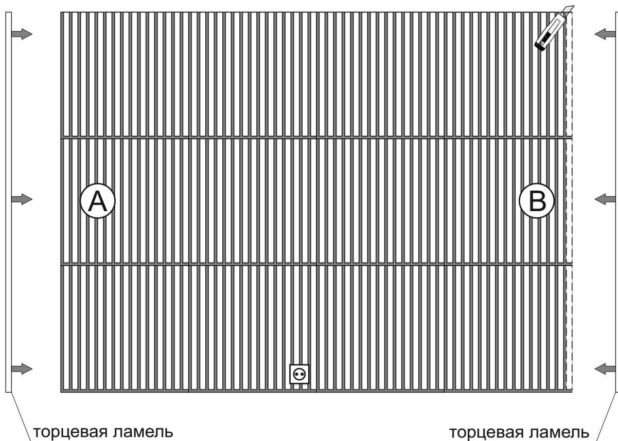
Отрежьте крайние ламели со стороны «В», оставив при этом край фетра 13мм. Замените отрезанные ламели торцевой ламелью, которая имеет размер 22x27мм. тем самым закройте торцы панелей
