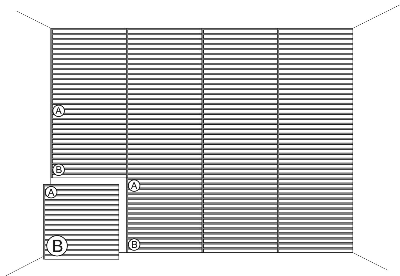
При монтаже панелей коллекции CUBE горизонтально, необходимо ориентироваться на базовый угол панели, обозначенный на рисунке буквой «В», имеющий выступающие части фетра. Последующие панели необходимо монтировать совмещая углы «А+В»
