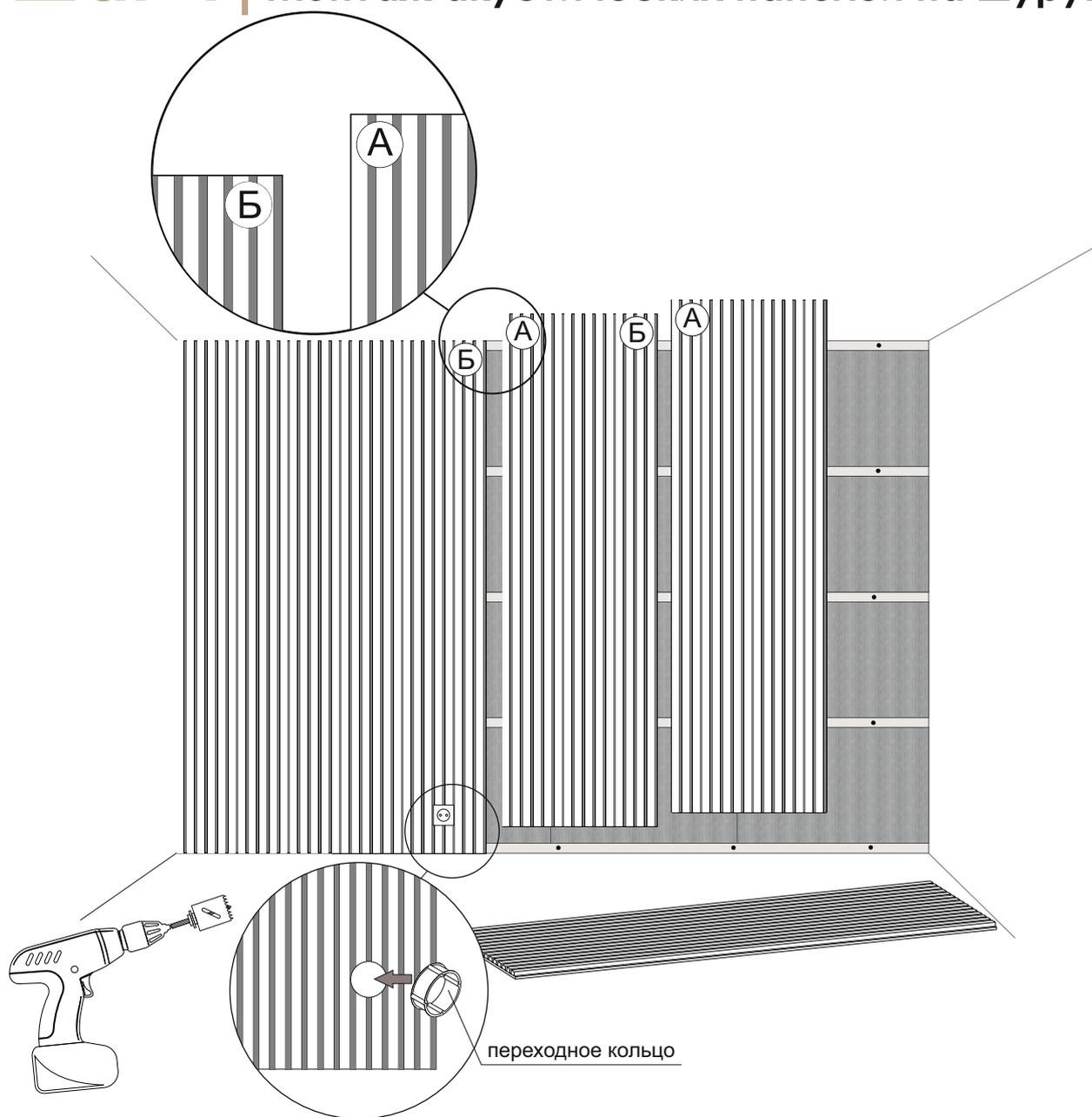
При монтаже акустических панелей Wood App обратите внимание на стороны «А» и «Б» на панелях
