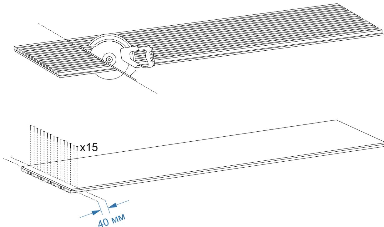
Если требуется изменить длину панели используйте циркулярную пилу или ручную пилу с мелким зубом
