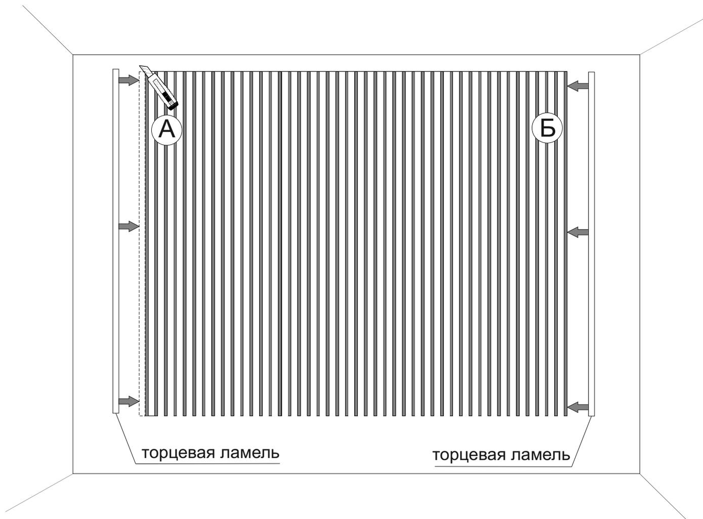
Отрежьте крайнюю ламель со стороны «А», оставив при этом край фетра 13мм. Замените отрезанную ламель торцевой ламелью, которая имеет размер 22x27мм. тем самым закройте торец панели
