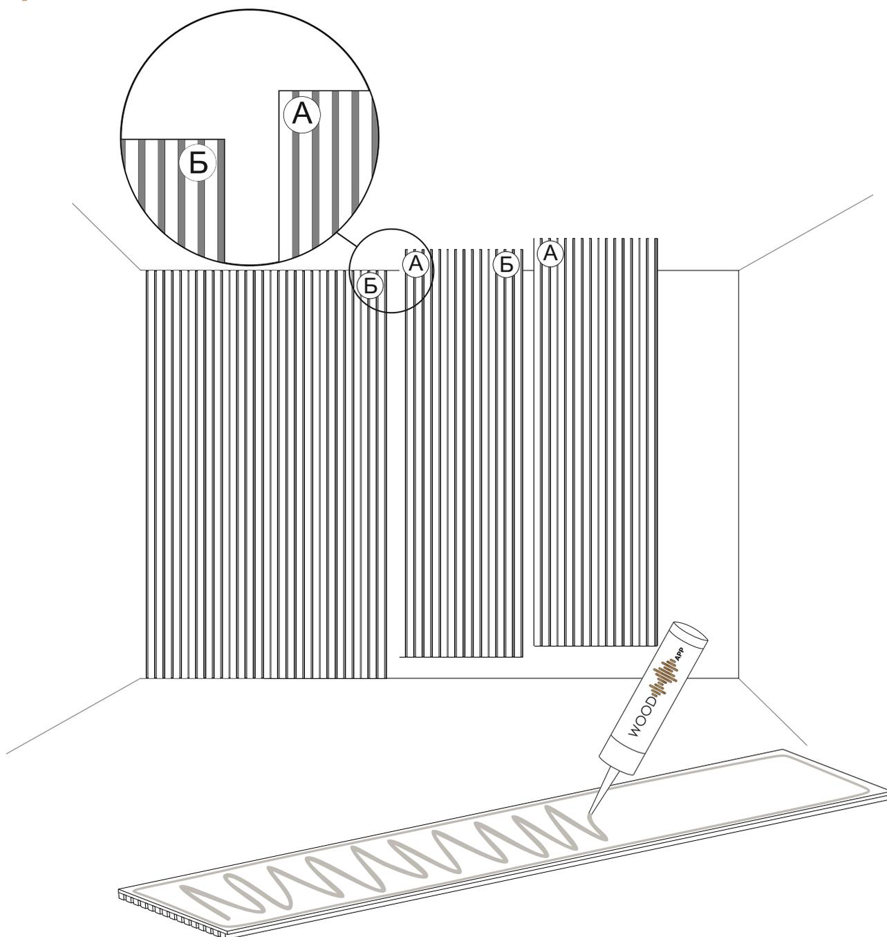
Монтаж панелей Wood App возможен так же и на специальный клей, при этом стена должна быть ровной, без выпирающих дефектов
