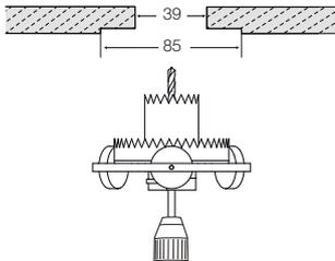
При установке большого количества безрамочных светильников рекомендуется использование двухуровневого инструмента с коронками **POINT S TOOL**
