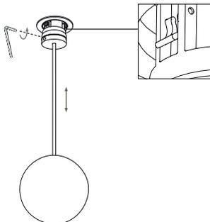
При установке светильника монтажные клипсы должны быть направлены вниз / Mounting clips must be directed down during the installation of the luminaire
