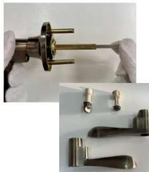
Шаг 4: Вытаскиваем металлический поршень из соединительного квадрата. Достаем фиксатор и заглушку/цилиндр из основания рукоятей. Меняем их местами и фиксируем на основании ручки (для этого необходимо попасть в пазы метал. язычком).
