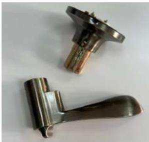
Шаг 2: Прокручиваем рукоять относительно основания и находим маленькое овальное отверстие. В центре данного отверстия должен оказаться металлический прямоугольный язычок. Острый концом ключа для монтажа поддеваем с усилием данный язычок, после чего рукоять должна выйти из основания ручки.
