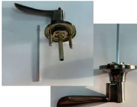
Шаг 5: Переворачиваем металлический поршень на 180 градусов (сверху вниз) и вставляем концом с утолщением в соединительный квадрат половинки ручки с заглушкой.
