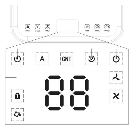
После подключения к источнику электропитания, все индикаторы на дисплее отобразятся и выключатся. После звукового сигнала осушитель POWER перейдет в режим ожидания. Нажмите кнопку POWER для включения осушителя. Осушитель включится с предустановленной целевой относительной влажностью 60% и с высокой скоротью вращения вентилятора. Для выключения нажмите кнопку POWER еще раз.
