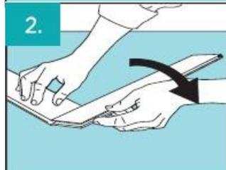
2. **Присоедините следующую панель.** Возьмите панель **В** и подсоедините ее длинной стороной к углу короткой стороны панели **А** как показано на рисунке. Прижмите панель **В** к полу до конца для того, чтобы закрепить. Убедитесь, что пазы на двух панелях образуют непрерывную линию.
