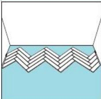
9. **Завершите 4 пинии укладки.** Установите дополнительные панели, чтобы получить 4 полных готовых линии укладки.
