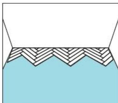
**13. Установите еще несколько линий.** Соедините треугольник и путем добавления нескольких дополнительных линий панелей. Начинайте каждую линию слева направо с панелями А, заканчивайте нарезанными панелями (как в шаге 5), за тем установите все панели В в
