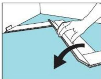
6. **Начните укладку второго ряда.** Начните второй ряд с панели **A**. Расположите новую панель напротив предыдущей, как показано на рисунке, и прижмите к полу, чтобы закрепить.
