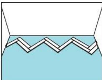
7. **Установите панели A.** Продолжайте укладку слева направо и установите все панели **A** во втором ряду. Заканчивайте, используя нарезанную по размеру завершающую панель (пример: шаг 5).
