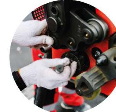
Настройте на станке глубину накатываемого желоба с помощью специального щупа и приступите к накатке желоба на труbe. В случае отсутствия щупа глубину паза можно установить при помощи ручки регулировки.
