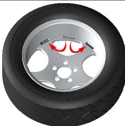
Поверните одну из этих спиц на «12 часов». Нажмите клавишу D и OPT для перехода в режим установки скрытых грузиков. Под надписью SPLIT загорятся все три лампочки, а также в окне дисбаланса скорректируется количество граммов. При этом, станок запомнит положение спицы и вычислит, положение второй спицы.
