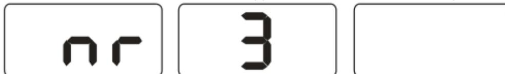
Измените согласно вашему колесу, количество спиц, клавишами b+ или b-. Подтвердите введенное количество, нажав клавишу D и OPT. После нажатия, на экране отобразятся показания дисбаланса внутри и снаружи.
