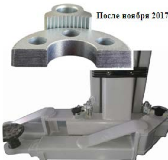
Рис. 3. Блокировка балок подхвата
