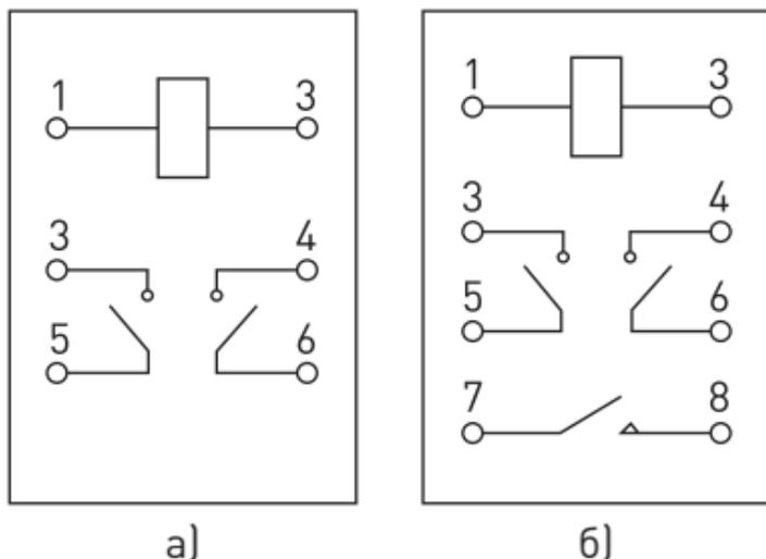
Рисунок 1. Схема электрическая для подключения внешних цепей
